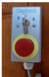
Unidad de control compuesta de interruptor de llave con botón de emergencia(OFF) en el control de hombre muerto y con el cableado de la central hidráulica.
