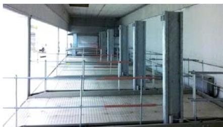
Plataformas superiores con placas de aluminio y cuña de manejo especial para ayudar a posicionar el vehículo.
